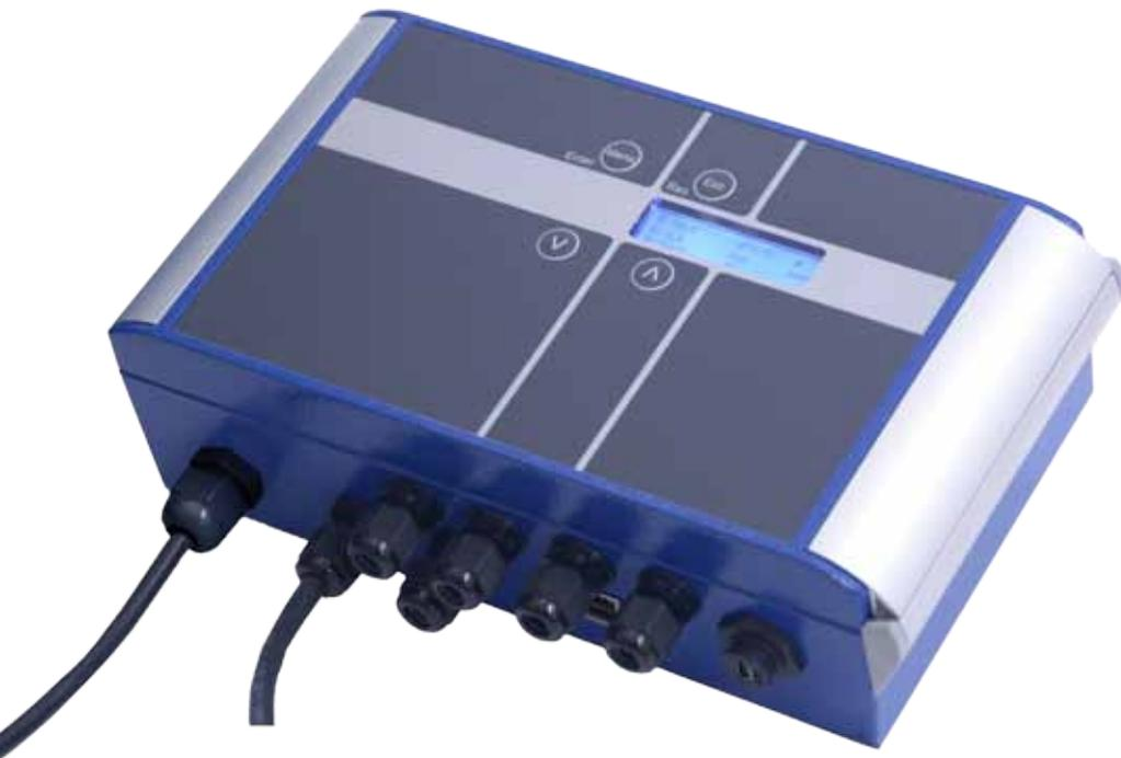
El VPFlowTerminal es una pantalla Plug and Play para montaje en pared con fuente de alimentación integrada y registrador de datos de 2 millones de puntos. El VPFlowTerminal tiene cinco entradas de sensores: una entrada para un VPFlowScope en línea o un medidor de inserción VPFlowScope, y cuatro entradas analógicas genéricas. Puede registrar hasta 8 canales. Gracias a esto, la recopilación y el análisis de los datos de su aire comprimido resultan más sencillos y rápidos.
