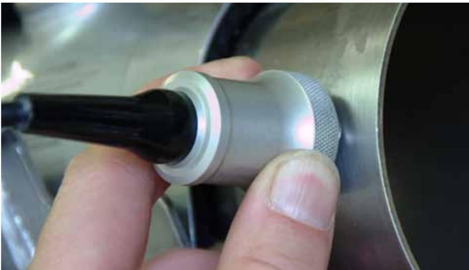
El calibre de grosor por ultrasonidos se usa para medir el grosor de las paredes, un dato clave a la hora de calcular el diámetro interior exacto de las tuberías.
